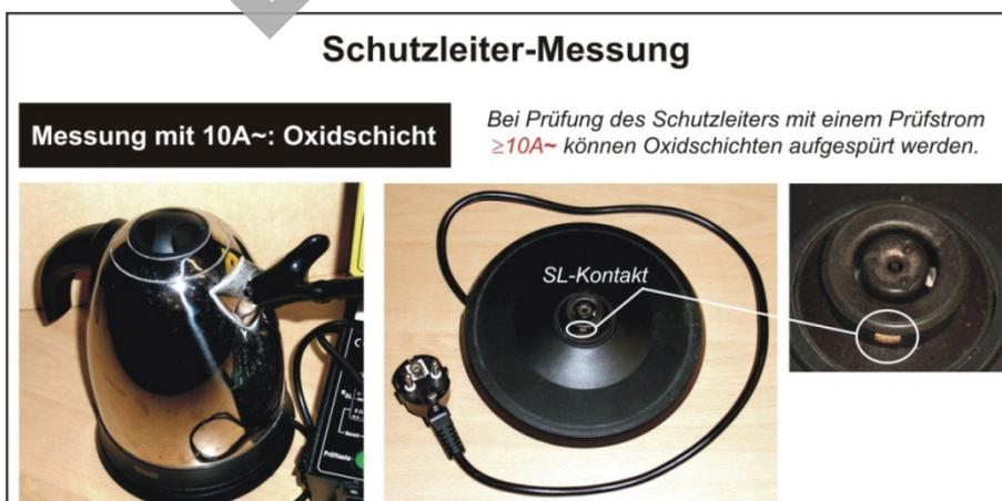
Bild 3: Schutzleitermessung mit 10A AC: Oxidschicht
