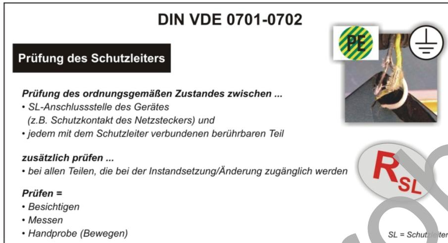
Bild 11: Prüfung des Schutzleiters (Geräteprüfung nach DIN VDE 0701-0702)
