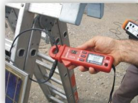
Bild 9: Erproben und Messen nach VDE 0126-23
